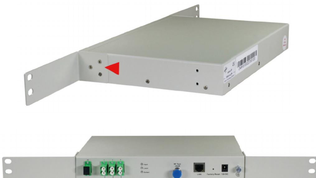
Abbildung 1c: OAMPc in einem 19 Zoll Schrank montieren
