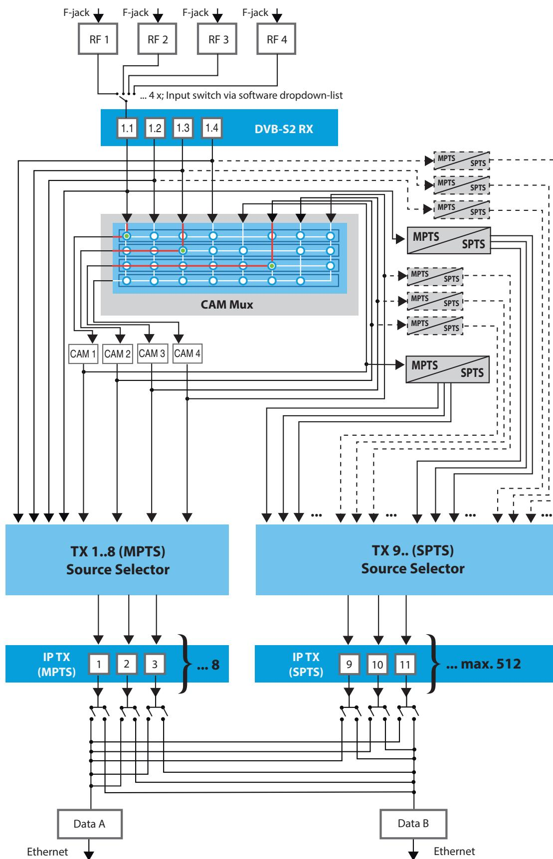
Bild 8: Signalfluss im U 144 und U 144-X
