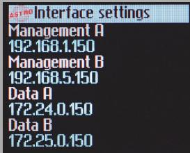
Um die Konfiguration des U 144 bzw. U 144-X vornehmen zu können, verbinden Sie nun eine der Netzwerkbuchsen (Management A bzw. Management B) an der Backplane des Geräts (siehe links) über ein Netzwerkkabel mit Ihrem PC oder Laptop.
