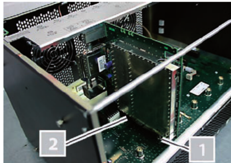
Bild 4a: Einbauzustand der Steckkarte (V 16 Basiseinheit)
